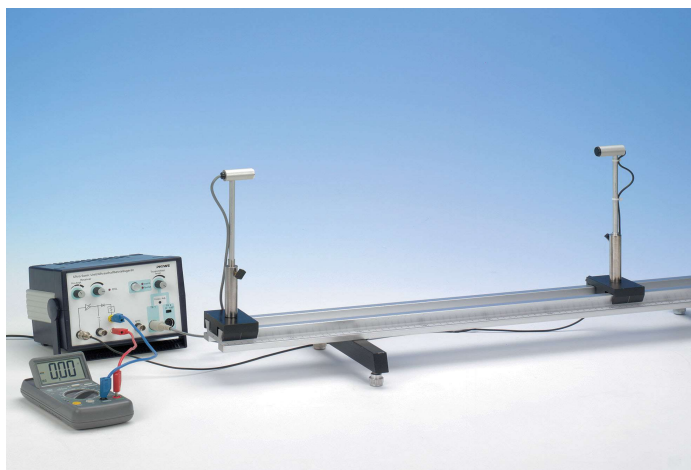
Rys.1. Zestaw pomiarowy do sprawdzania prawa absorpcji ultradźwięków w powietrzu.
